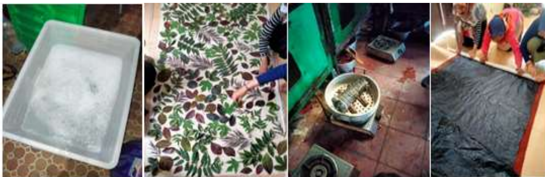
Gambar 1. Proses pembuatan batik ecoprint secara sederhana meliputi (dari kiri ke kanan): a) proses mordanting, b) proses percetakan, c) proses steam, d) membuka kain hasil cetakan
