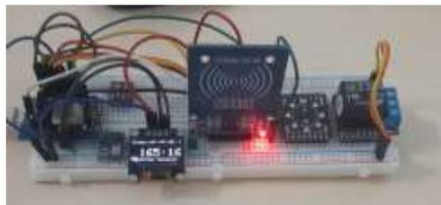
Gambar 4 rangkain elektrik writer/reader RFID
